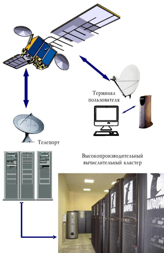
Рис. 1. Структура информационной среды для высокопроизводительных вычислений в биомедицине
